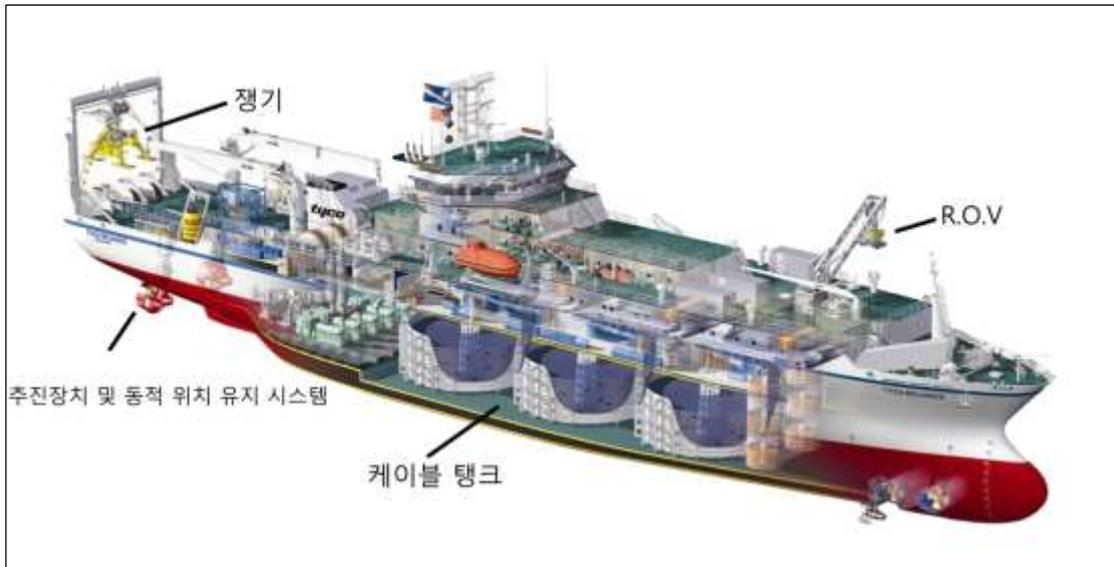
그림 6. 해저 케이블 설치선의 부분 단면도
