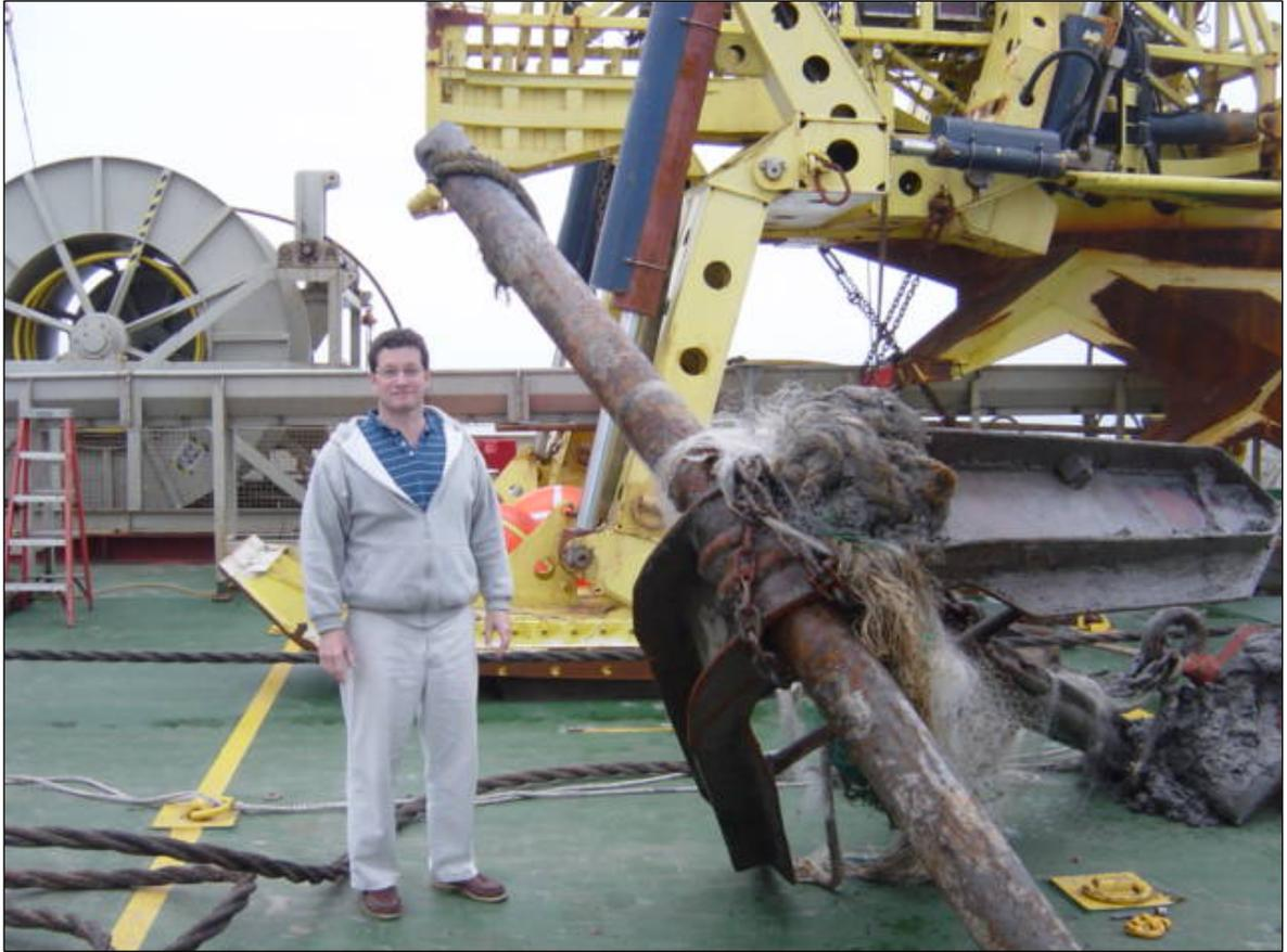
**Ilustración 21.** Ancla recuperada con extremo de cable
