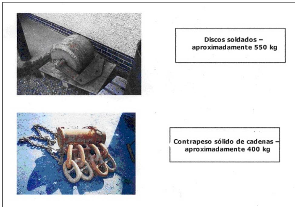
**Ilustración 14.** Ejemplos de contrapesos usados en redes de arrastre dobles/triples
