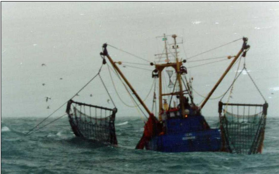
**Ilustración 29.** Barco arrastrero de vara atascado en un cable fuera de uso.
